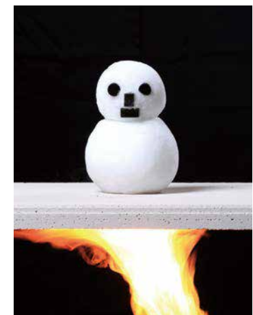
パワーボードの上に雪だるまを乗せて、バーナーで加熱。溶けずに残りました。
